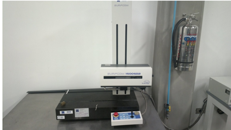
Fig. 1. Rugosímetro CARL ZEISS modelo SURFCOM 1500SD2.
