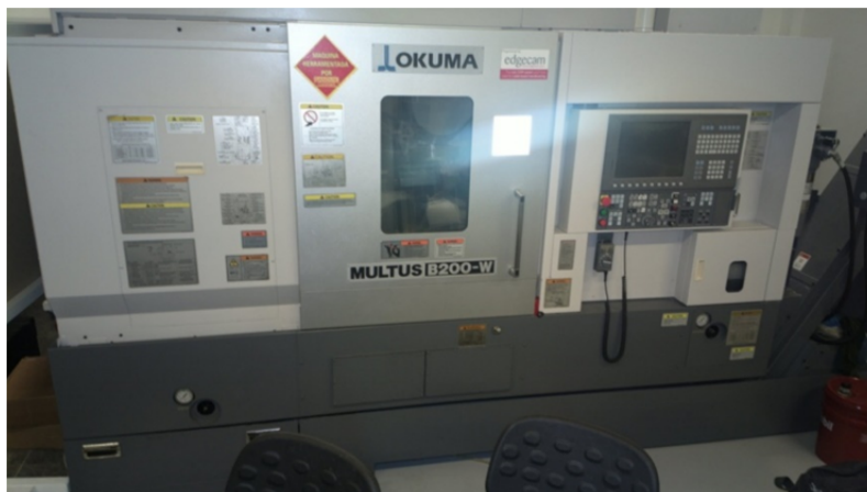
Fig. 3. Torno multifuncional CNC marca Okuma modelo Multus B-200W.
